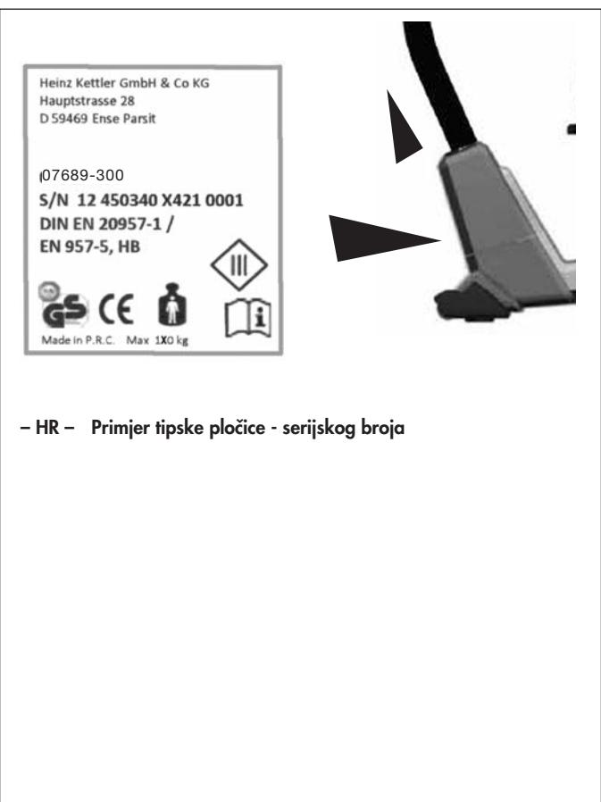
– HR – Primjer tipske pločice - serijskog broja
